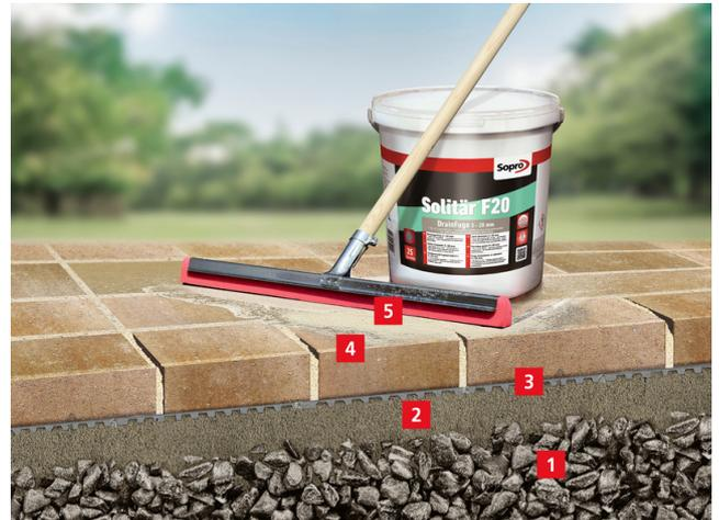
Aufbau auf gebundener Bettung: 1. Verdichtete Schotterschicht; 2. Sopro DrainageMörtel DM 610; 3. Fliesenkleber, z. B. Sopro's No.1, rückseitig aufgezehnt im Buttering Verfahren; 4. Betonwerksteinplatten; 5. Fugenmörtel Sopro Solitär® F20
